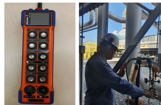
Figura 23 – Controle remoto que permite a calibração em malha por apenas um profissional
